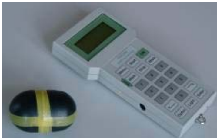
Bild 7: Elektronische Kartoffel PTR-200 von SM Engineering (Dänemark)
