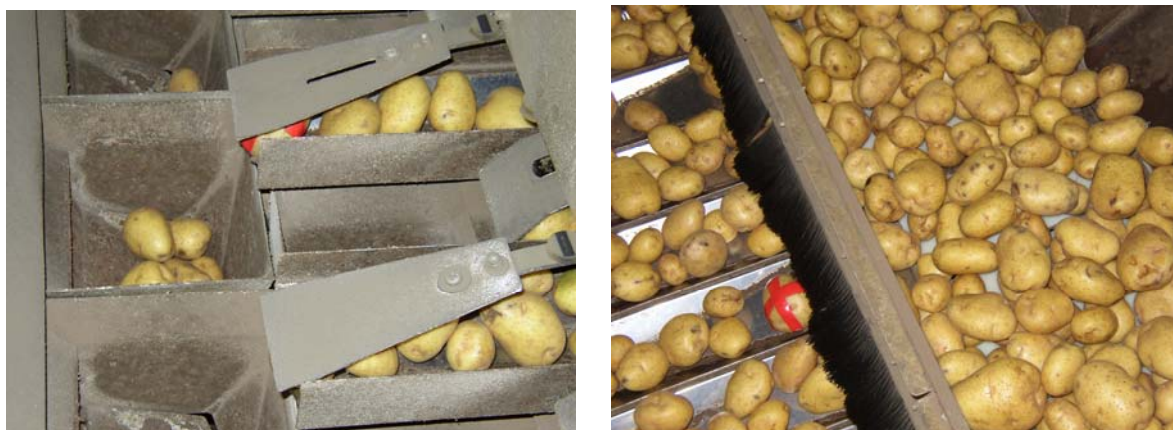
Bild 16: Implantat in Kartoffel (mit rotem Kunststoffband umklebt) in Abpackanlage
