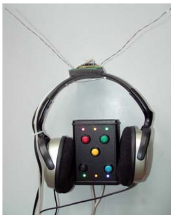
Bild 29: Prototyp der Empfangseinheit (HF-Empfänger oben auf dem Kopfhörerbügel montiert, Handgerät zwischen die Ohrmuscheln gelegt)
