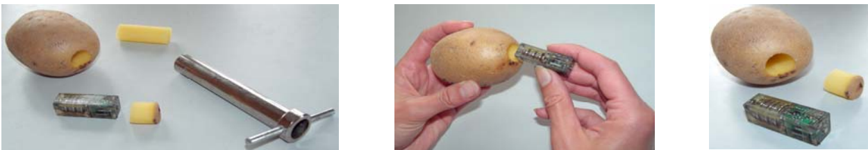
Bild 38: Implantieren des Messkörpers in eine Kartoffel
