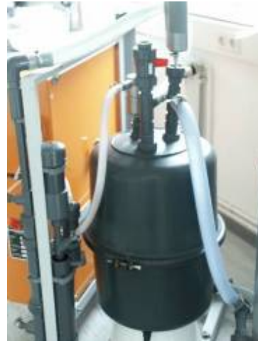
Bild 5: Ozongenerator, Rückansicht mit Umbauten
