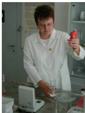
Bild 7: Probenentnahme zur Bestimmung der Ozonkonzentration
