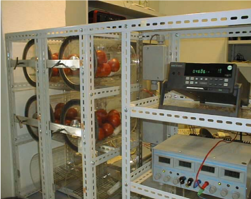
Bild 1-2: Messung von Atmungsaktivitäten im Anreicherungsverfahren
