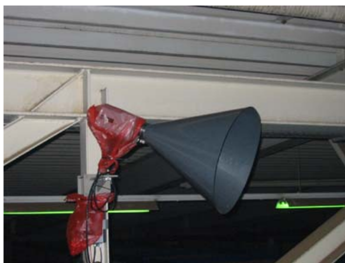
Bild 5.1: IR-Kamera ThermaCam SC 500 am stationären Messplatz im Kartoffellager Weidendorf im Einsatz mit Feuchtigkeits- und Staubschutz
