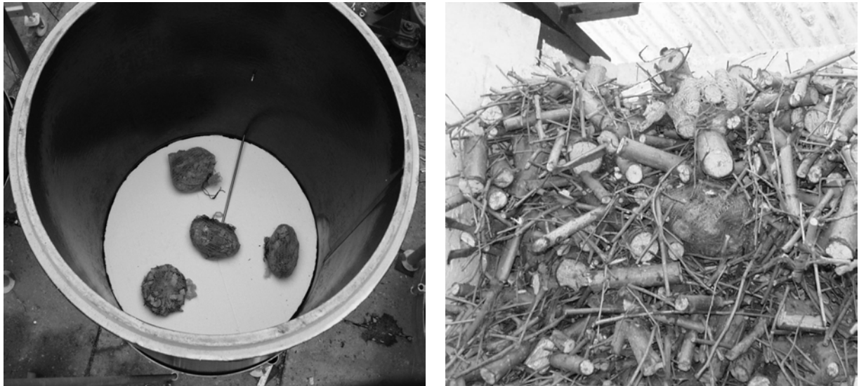
Bild 3-33: Bilanzbeutel bei der Einlagerung in die Lagersilos (links) und bei der Auslagerung in den Lagerboxen (rechts), Saison 2002
