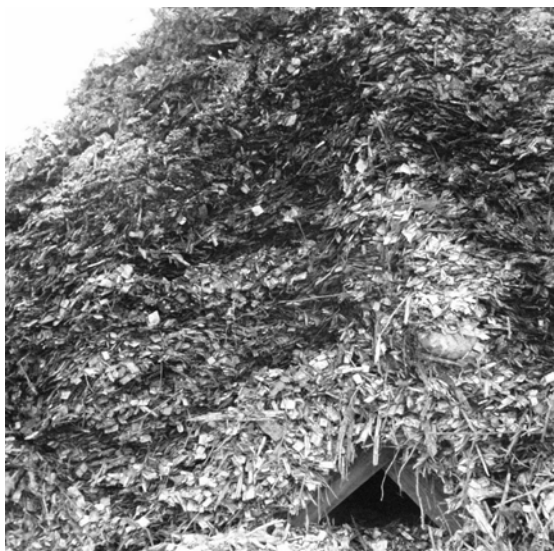
Bild 4-60: Querschnitt des 70 m 3 -Feldrandlagerhaufens mit Luftkanal bei der Auslagerung der Pappel-Mittelhackschnitzel HS 36 (Saison 2002)
