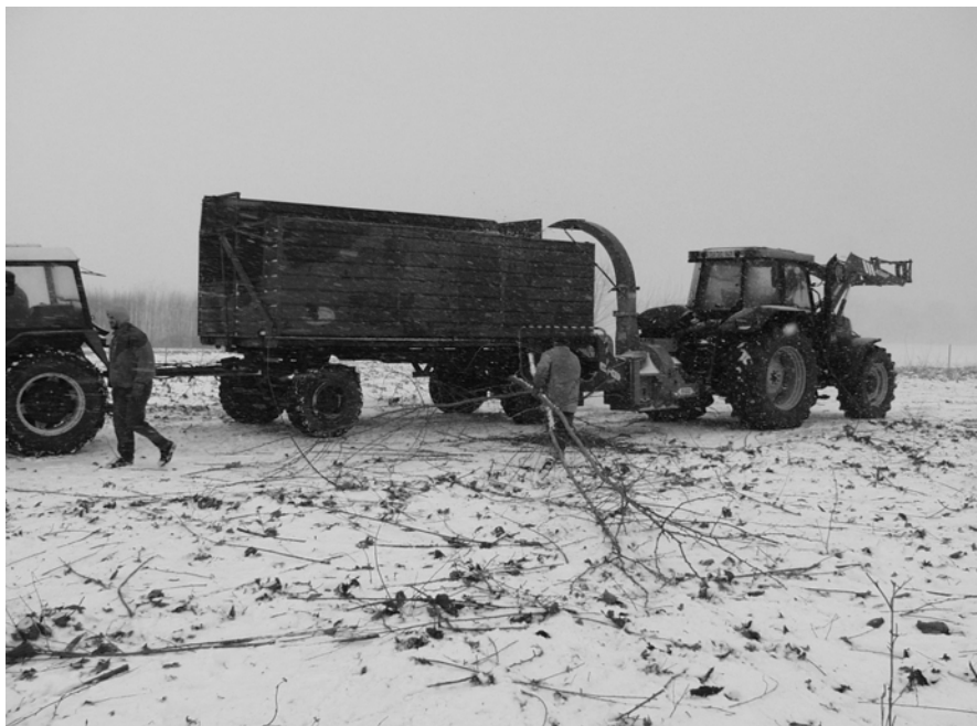
Bild 3-1: Hackschnitzelerzeugung mit dem Anbauhacker der Fa. Laimet auf der Energieplantage des ATB
