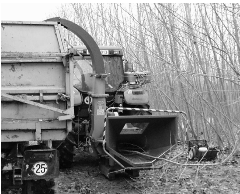
Bild 3-3: Schneckenhacker der Fa. Laimet, Pappelernte 2002 in der Energieplantage des ATB
