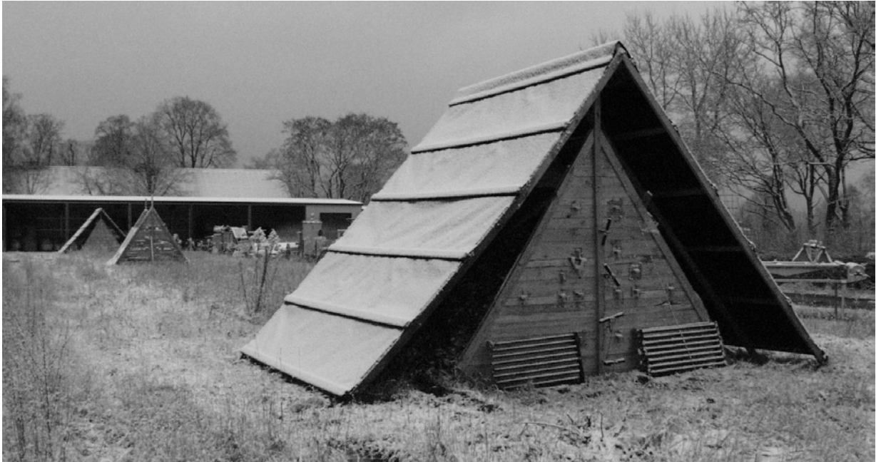
Bild 3-21: Abgedeckte und nicht abgedeckte Lagerhaufen mit Messstellen und Entnahmeöffnungen an der Stirnseite, Saison 2002
