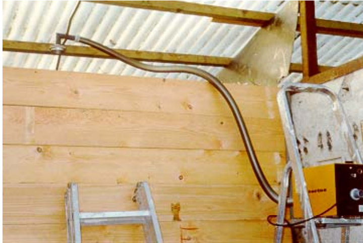
Bild 3-49: Messung der Sporenkonzentration der Schimmelpilze in der Luft über der 10 m 3 -Lagerbox
