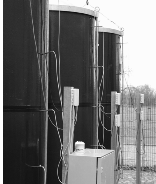
Bild 3-28: Temperaturmessung in Lagerhaufen (links) und Silos (rechts) (Saison 2002)
