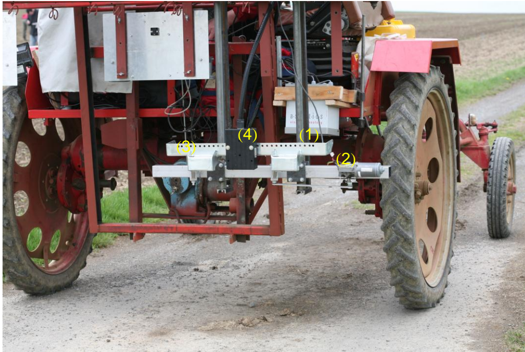
Bild 1: Befestigung des MiniVeg ® -Sensors an das Gestänge des Trägerfahrzeugs mit Halterung (1), Antrieb (2), beweglicher Arm (3) und Messkopf (4)
