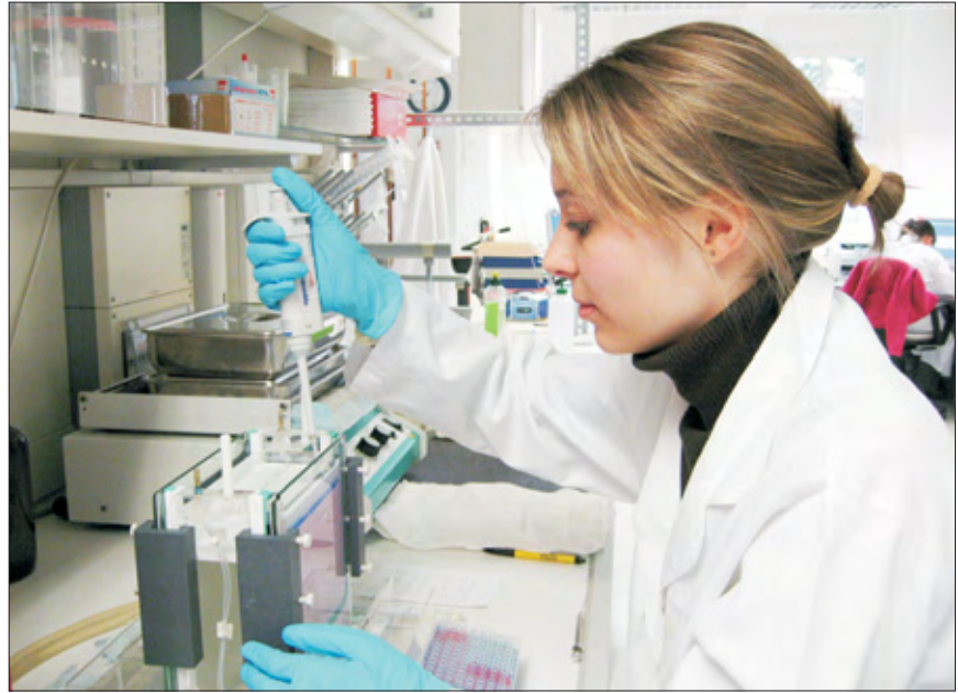
2 Beladung eines Acrylamidgels zur Analyse genomischer DNS.
