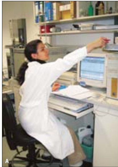
B (A) Gaschromatographische Analyse kurzketziger Fettsäuren. (B) Bestimmung von Gallensäuren in Intestinalinhalten und Fäzes mittels Hochleistungs-Flüssigkeits-Chromatographie (HPLC).
