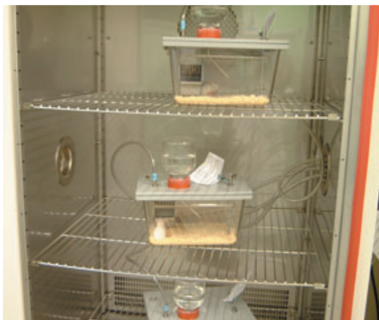
Abbildung 1 Messung des Energieumsatzes von Mäusen in vivo durch indirekte Kalorimetrie.
