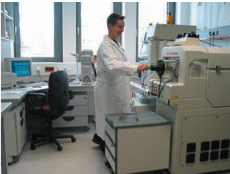
Abbildung 4 LC-MS-MS (Hochdruck-Flüssigkeitschromatographie mit Tandem-Massenspektrometrie) zur Bestimmung von Mercaptursäuren und Basen-/Nucleosid-Addukten.
