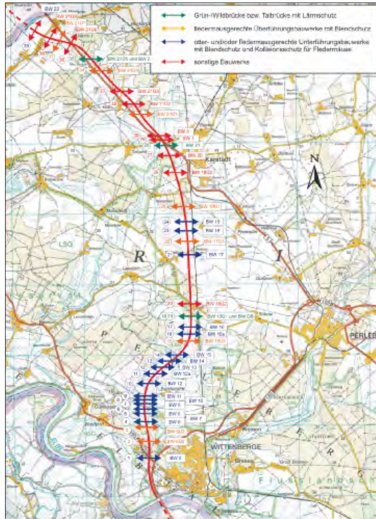
■ Tierquerungshilfen im Zuge der A 14 im Land Brandenburg
