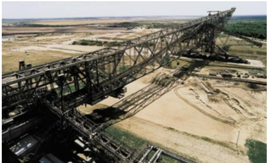
In Lichterfeld steht ein Gigant der Technik: 502 Meter lang, 202 Meter breit, 80 Meter hoch, 11.000 Tonnen schwer, erzählt die ehemalige Abraumförderbrücke F60 von der Geschichte und Gegenwart des Braunkohlenbergbaus in der Lausitz.
