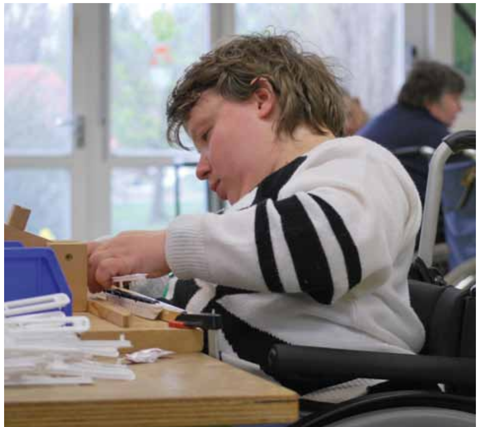
Jacqueline S. setzt Drehlüfter für Fenster zusammen
