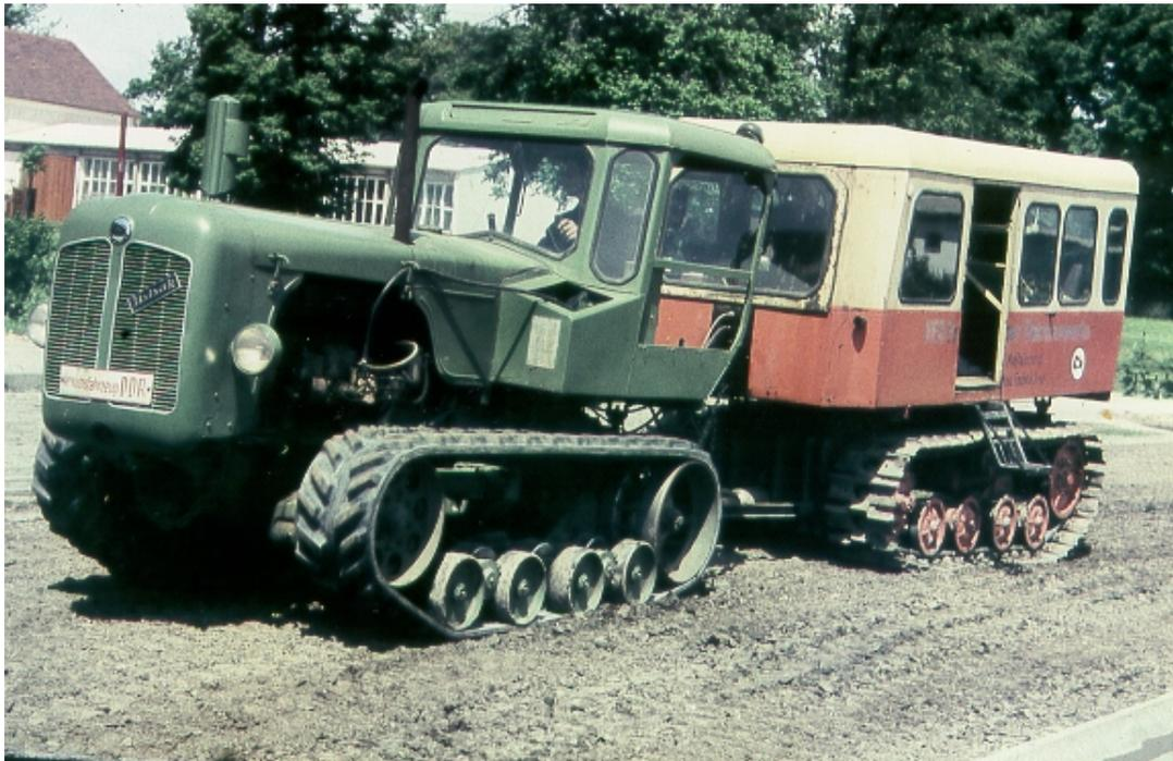
Bild 5: Dederonverstärkte Gummigleisbänder am 60-PS-Kettenschlepper KS-30 des Brandenburger Traktorenwerks bei Zugkraftmessungen auf der Tonbahn
