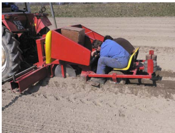
Bild 1: Christbaumpflanzgerät beim 2-reihigen Setzen von Weidenstecklingen
