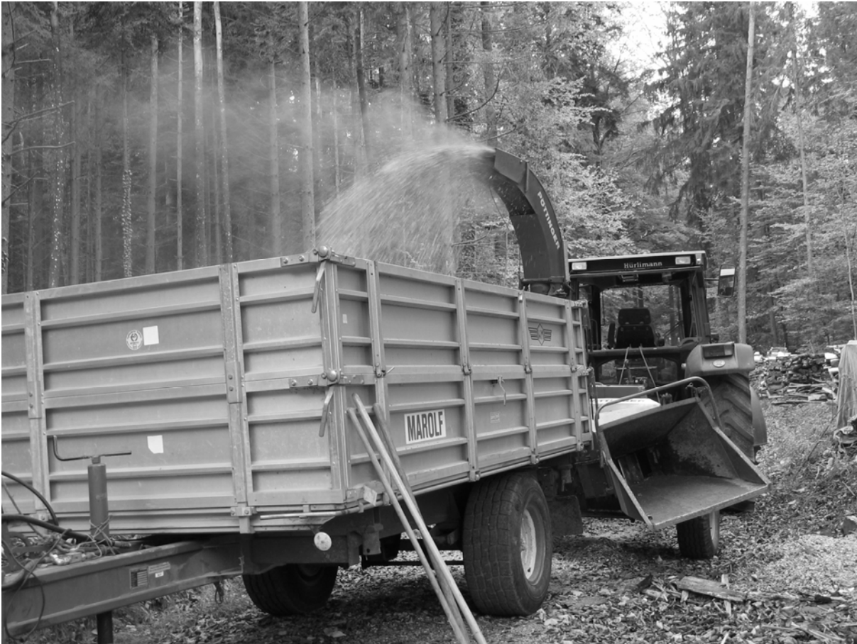
Bild 2: Zapfwellenbetriebene Anbau- oder Anhängehacker eignen sich für den Einsatz im bäuerlichen Forst
