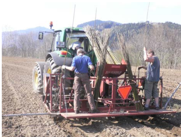
Bild 5: 4-reihiges Setzgerät mit Rutenschneidsystem (Step planter)
