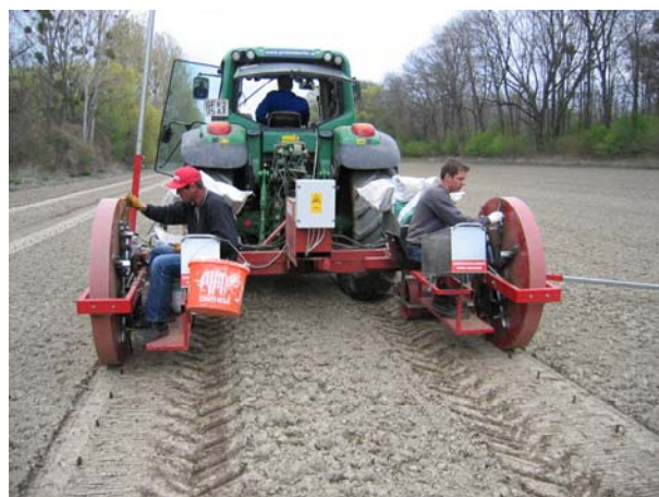
Bild 3: 2-reihiges Setzgerät mit Zangensetzelementen (Spapperi)
