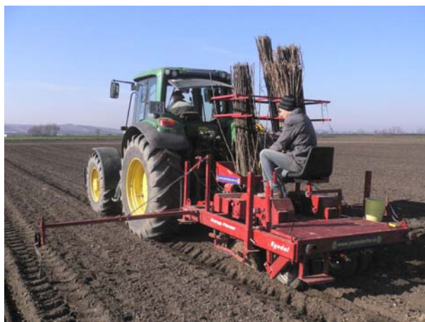
Bild 4: 2-reihiges Setzgerät mit Rutenschneidsystem (Egedal)
