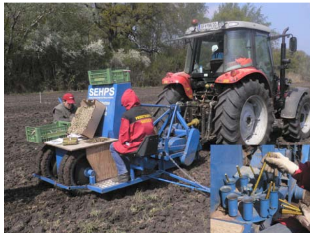
Bild 2: 2-reihiges Setzgerät mit Drehmagazin und vorgeschalteter Bodenfräse (SEHPS)
