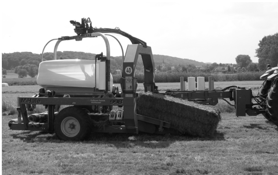
Bild 2: Während ein Ballen noch gewickelt wird, kann ein zweiter bereits aufgenommen werden. Dies steigert die Leistung des Gerätes erheblich
