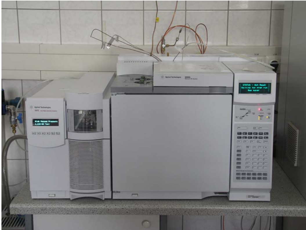
Abbildung 29: GC-MS Gasanalyse-System für die Spurengasmessung
