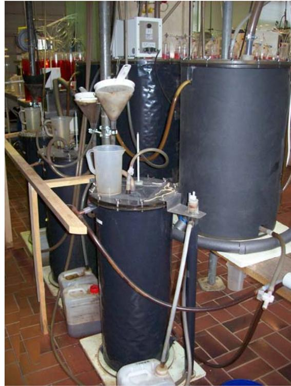
**Bild 2:** Speicher für die Prozessflüssigkeit und Methanreaktor
