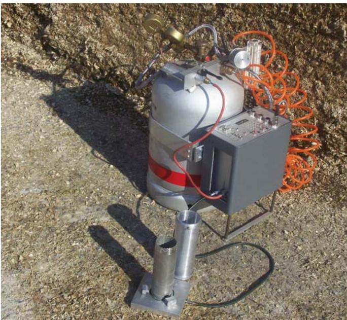
**Bild 2:** Apparatur zur Bestimmung des Porenvolumens beim Einsatz im Silo
