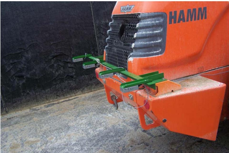
**Bild 6:** Optische Abstandssensoren zur Messung der Einsinktiefe des Verdichterfahrzeugs
