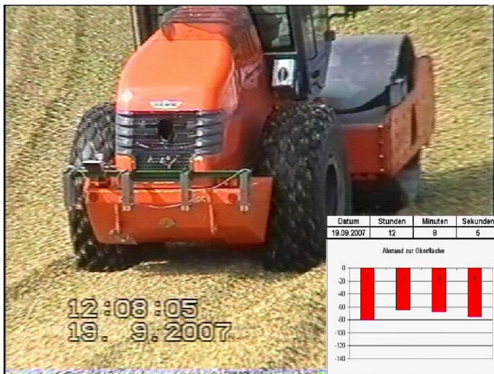
**Bild 7:** Einblenden dynamischer Diagramme in das Video der Verdichterfahrt
