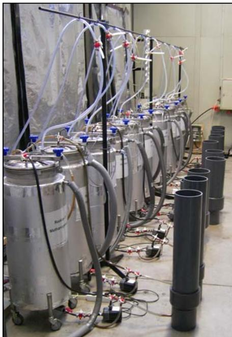
**Bild 2:** Versuchsbiogasanlage zur zweiphasigen Vergärung von Grassilage an der Universität Hohenheim
