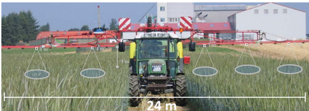
Abbildung 2: Mögliche Aufnahmekonfiguration des Penta-Spek Systems
