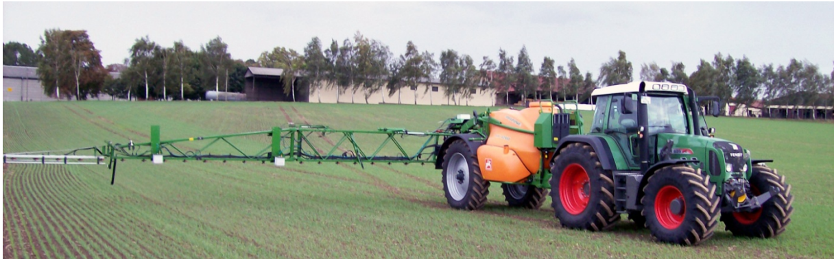
Abbildung 1: Einsatz des H-Sensors im Herbst 2009 mit einer handelsüblichen Feldspritze
