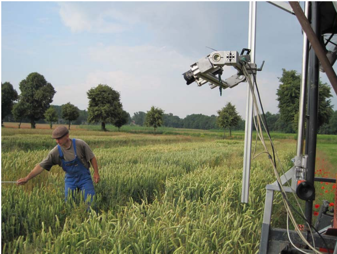
Abbildung 1: Farbbild- und Multispektralkamera an einem variabel einstellbaren Kameraträger für Bildaufnahmen in den Parzellenversuchen
