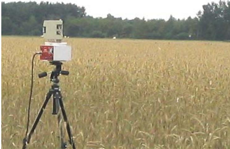
**Bild 3:** Messaufbau zur 3D Erfassung von Pflanzenbeständen
