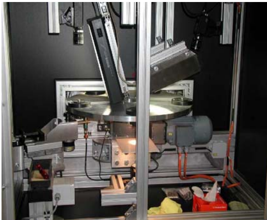
Bild 4: Montageanlage für Spinddüsen mit integrierter Qualitätskontrolle
