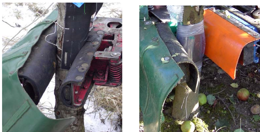
Bild 1: Rüttelwerkzeuge mit unterschiedlicher Polsterung: a – Polsterung mit U-Profilgummi (über mit Schaumstoff gefüllten Gummischlauch), b – Polsterung mit homogenem Blockgummi
