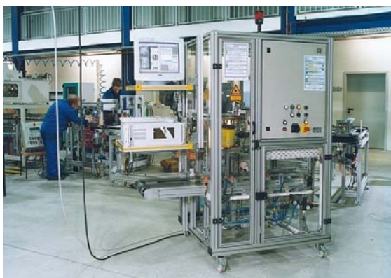
Bild 1: Aufdruckkontrolle mit SYMA-CON-VISION
