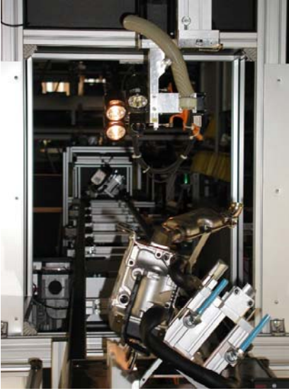
Bild 5: Montageanlage mit zwei Kameras am Arm einer 5-Achs-Einheit
