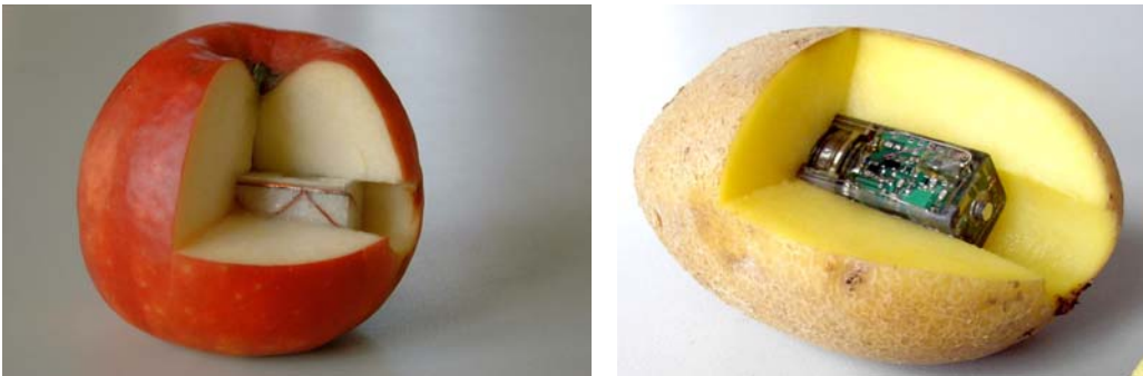
Bild 1: Messkörper mit 3D-Beschleunigungssensoren im Fruchttinneren
