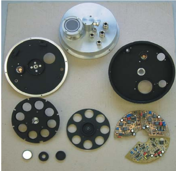
Bild 3: Komponenten des AOS-Sensors (von oben im Uhrzeigersinn: Gehäuseoberteil, Aufnahme für die Umgebungslicht-Fotodiode, Verstärkungselektronik, Aufnahme für die Bandpassfilter und Filter, Gehäuseunterteil mit Aufnahme für die Sichtfeld-Fotodiode)
