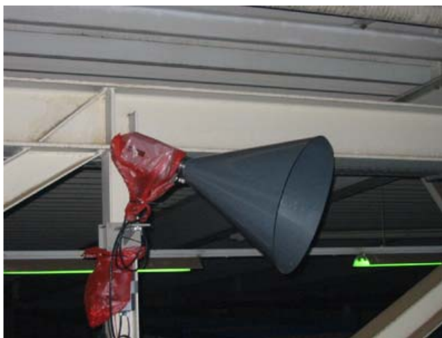
Bild 3: Thermographiekamera ThermoCam SC 500 (FLIR Systems GmbH) am stationären Messplatz mit Staub- und Feuchteschutz, der als Trichter ausgebildet ist
