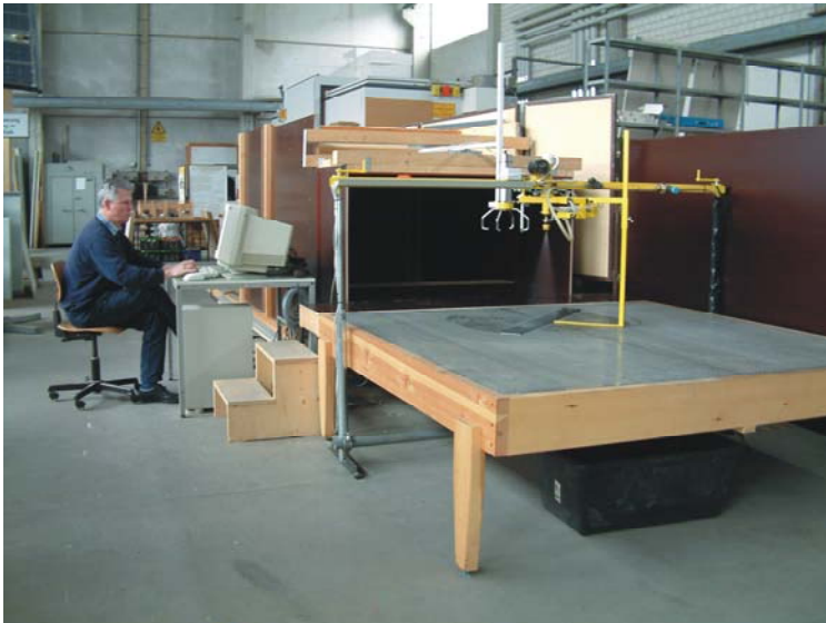
Bild 2: Prüfstand zur windabhängigen Spritzdüsenverstellung
