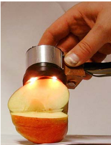
Bild 1: Sensorkopf für partielle Lichttransmission am Apfel
