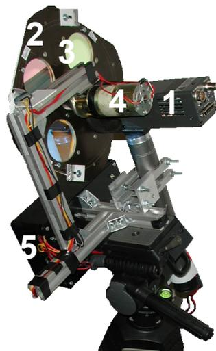
Bild 1: Multispektrale Aufnahmeeinheit mit Kamera (1), Filterrad (2), Filter (3), Motor (4) und Steuereinheit (5)
