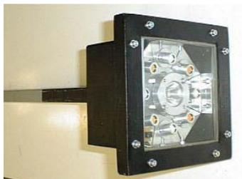
Bild 3: Testaufbau eines Boden/Pflanze-Sensors mit Photodioden
