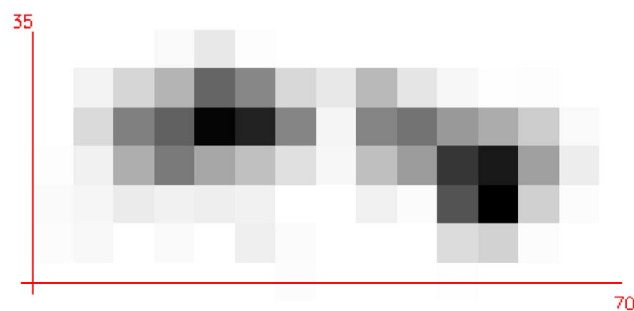
Bild 3: Relative Verweildauer einer Hand im Arbeitsprozess; je dunkler desto länger ist die Verweildauer (Maßangaben in cm)
