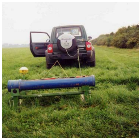
Bild 2: Messgerät EM38 und Transportfahrzeug zur Messung der Bodenheterogenität
