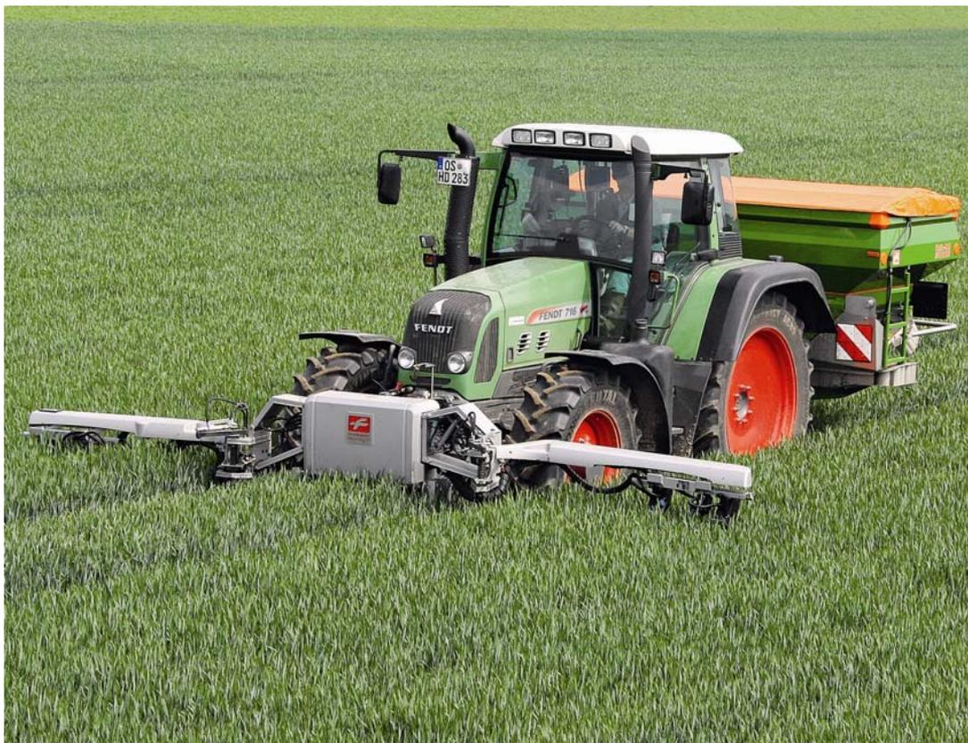
**Abbildung 1:** MiniVeg N-System: Messung von Fluoreszenzsignal, Bestandesdichte und Pflanzenhöhe
