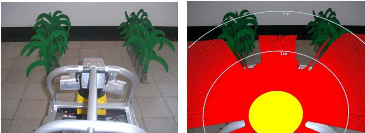
**Abbildung 4:** 2D-Laserscanner zur Detektion von Reihenkulturen
