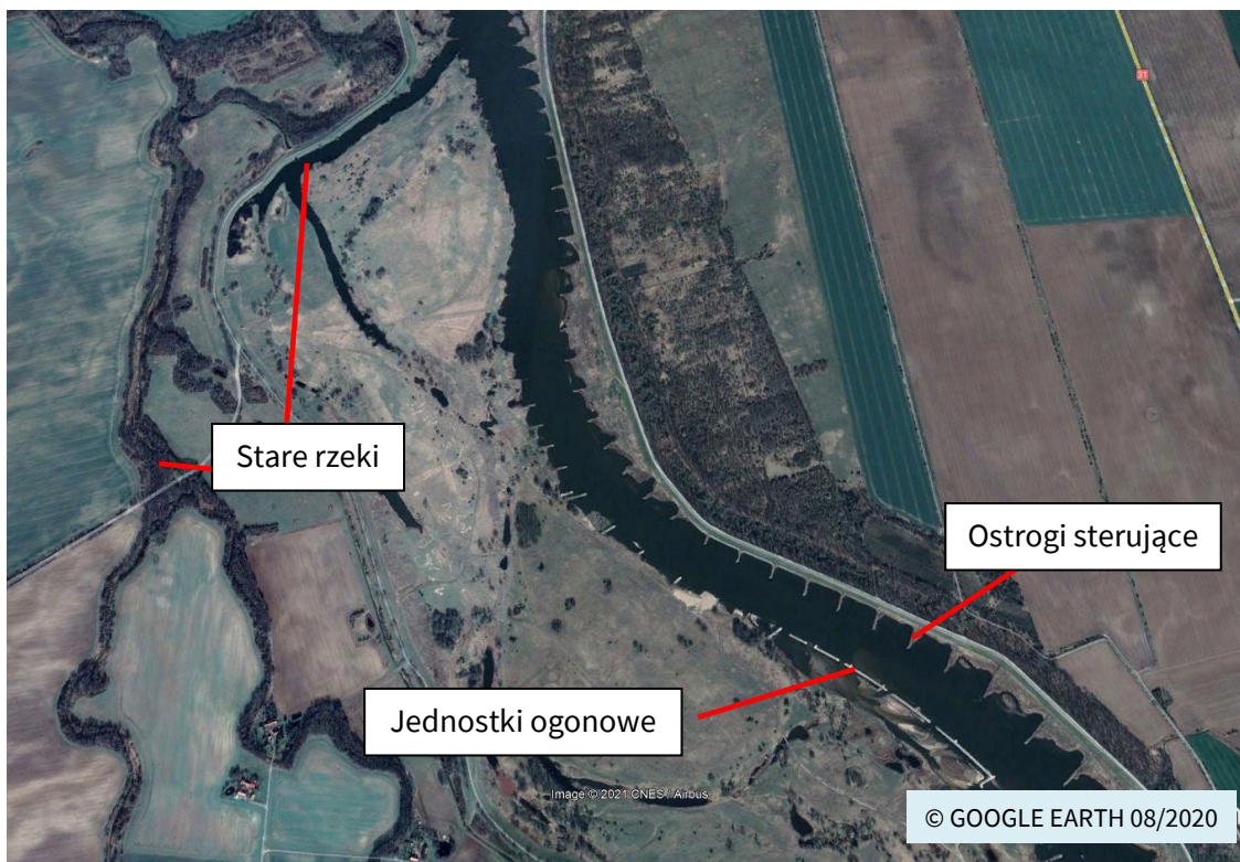
Ilustracja 8: Odra w Reitwein z ostrogami, konstrukcjami prowadzącymi i dawnymi stare zakole Odry
