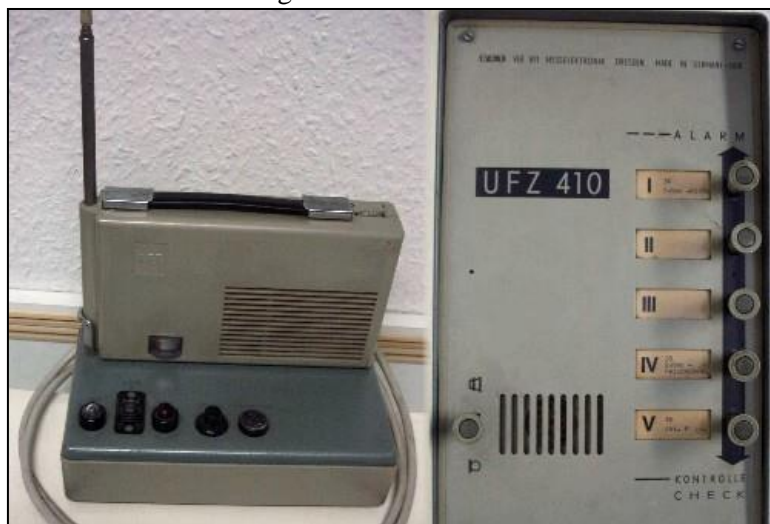
Empfangsteil und Sendeteil mit integriertem Mikrophon der UFT 212
