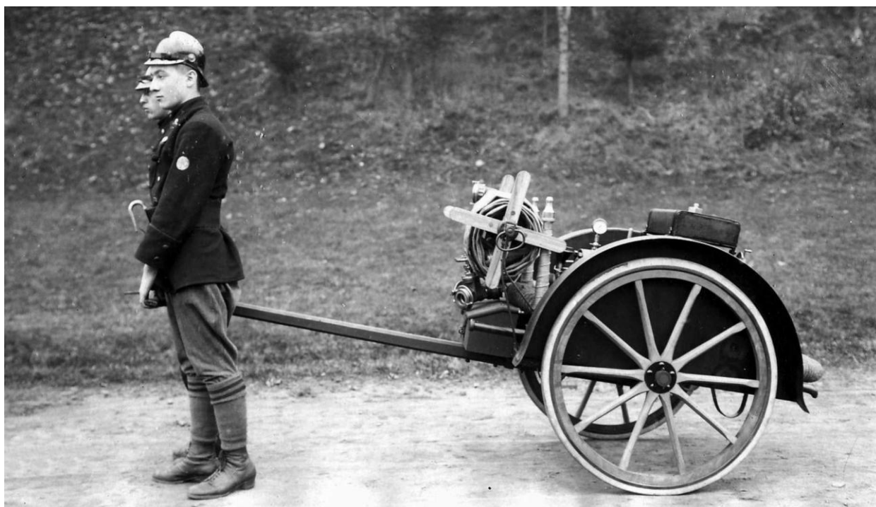
Eine der ersten FLADER Kleinmotorspritzen auf einem ungefederten Transportanhänger.
