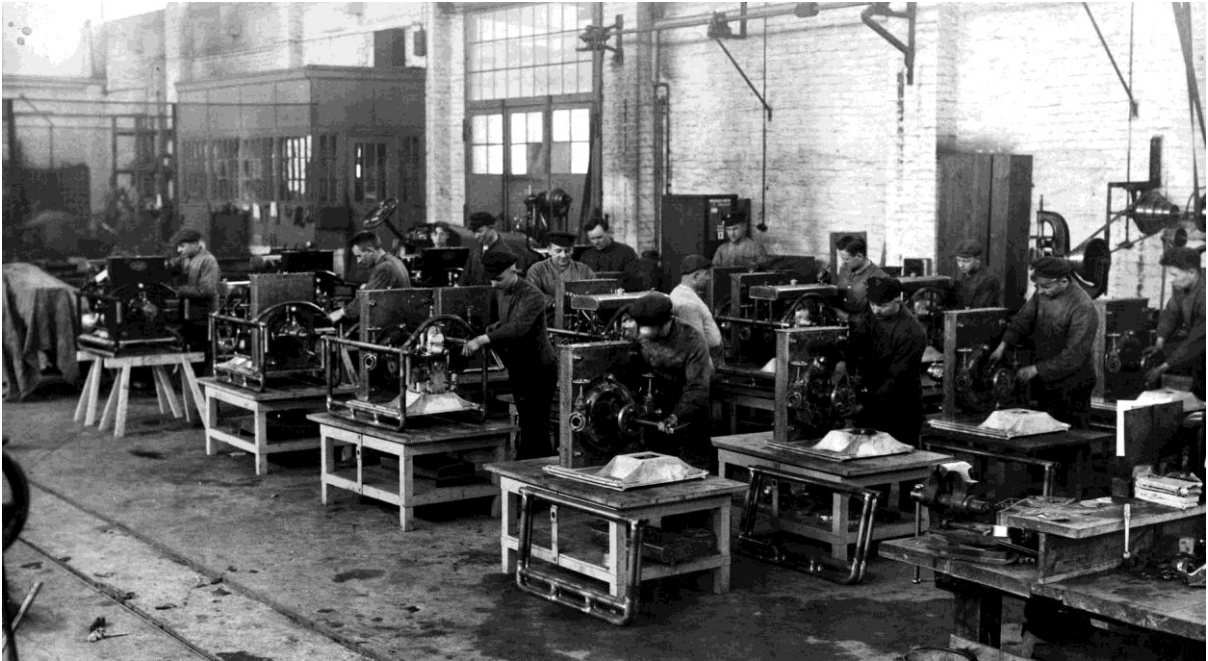
Fertigung von Kleinmotorspritzern bei der Firma KOEBE
