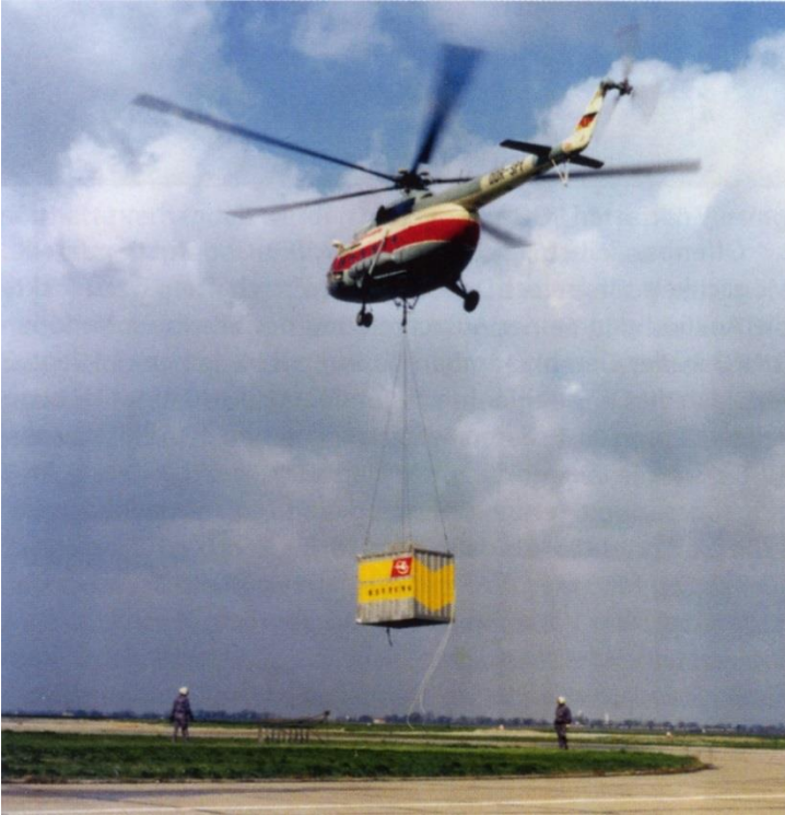
(14) Flugversuche mit Mil Mi-8T, SN:10596, DDR-SPF, der Interflug, mit untergehängtem Rettungscontainer Ekpt-N auf dem Flughafen Berlin-Schönefeld im Auftrag der Zivilverteidigung.
