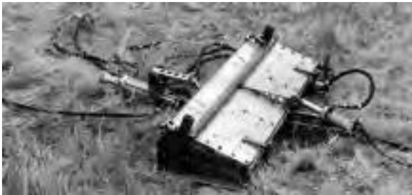
(5) Löschmittelabwurfanlage der PZL-106A
