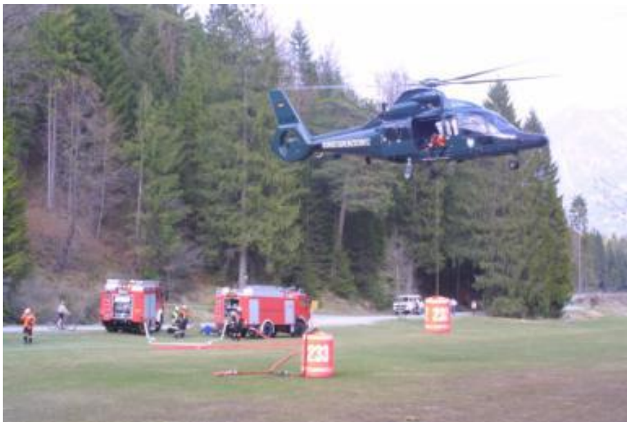
(22) Hubschrauber Eurocopter EC155 der Bundespolizei mit Außenlastbehältern Semat FPG im Jahr 2003
