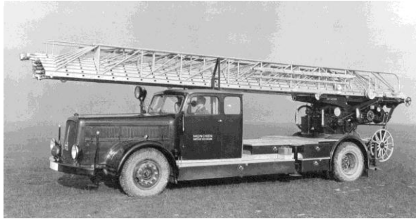
Kraftfahrleiter KL46 von Magirus auf Magirus Fahrgestell FLI 150, geliefert 1939 an die Feuerschutzpolizei München.
