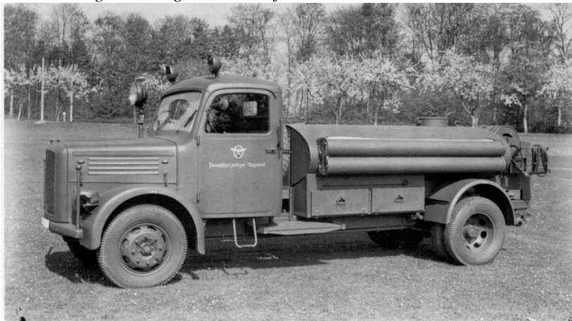
Ein Tanklöschfahrzeug TLF 15/43 (TS 1,5) als Tankspritze TSH 515 von Henschel auf einem Fahrgestell KHD FS 330 vom Mai 1943.
