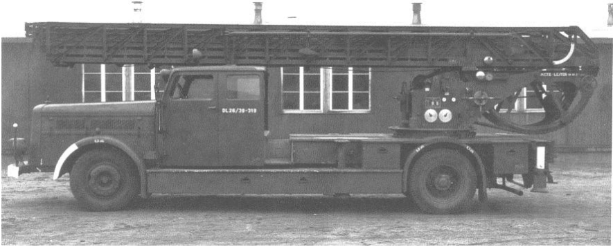
Eine DL26 (KL26) von Metz für die Luftwaffe Baujahr 1939 auf einem Fahrgestell FL 145 von Magirus.
