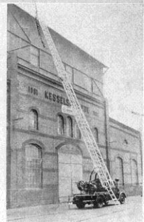
Typenbeschreibung der DL 17 (LDL) von Metz auf einem Mercedes Benz L 1500 Fahrgestell in einem Metz Firmen Katalog von 1943
