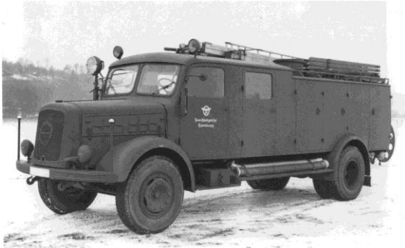
Ein Magirus LF25 (GLG) auf Magirus S4500 Fahrgestell vom Dezember 1942
