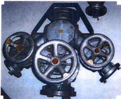
Verteiler A – schwere Ausführung
