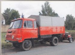
LF-LKW-TS 8-PLA auf LO 3000 der FF Burgliebenau (Eigenaufbau FF Ingenieurhochschule Cottbus von 1982)
