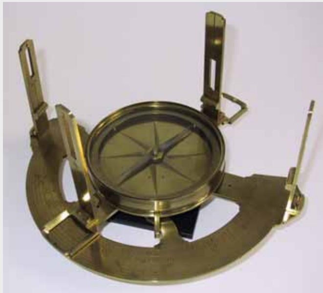
Bussole (Instrument zur Richtungs- bzw. Winkelmessung). J.L. Koch, Berlin, 1751 (Foto: Friedrich Balck)
