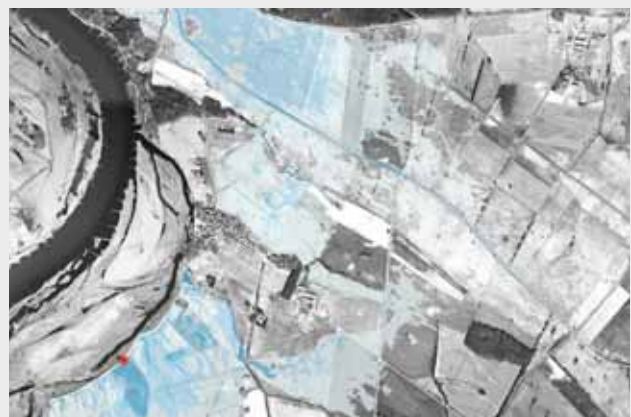
Situation nach 4 Stunden: Wasser breitet sich wenig entgegen der Fließrichtung der Elbe und hauptsächlich in Fließrichtung der Elbe der Geländeform folgend zur Karthäne hin aus, Straße Rühstädt – Bälów noch passierbar.
