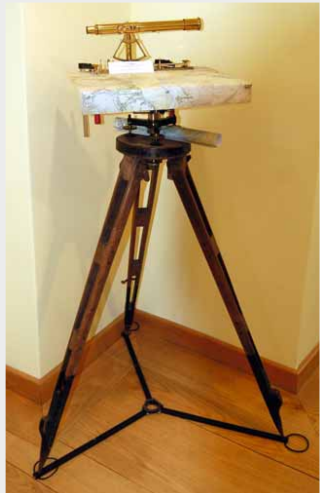
Messtisch mit Kippregel zum Einstellen und Markieren der Richtung von aufzunehmenden Punkten um 1800, Nachbau (Foto: Ulrich Rath)
