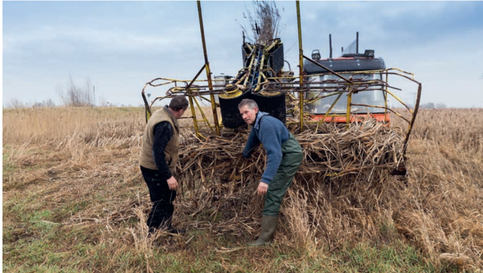
Abbildung 1: Arbeit mit dem Pistenbulli. Zur Schilfernte bereits sehr gut geeignet, braucht das Schneidewerk noch Anpassungen, um bei der Rohrkolbenernte eingesetzt zu werden.
