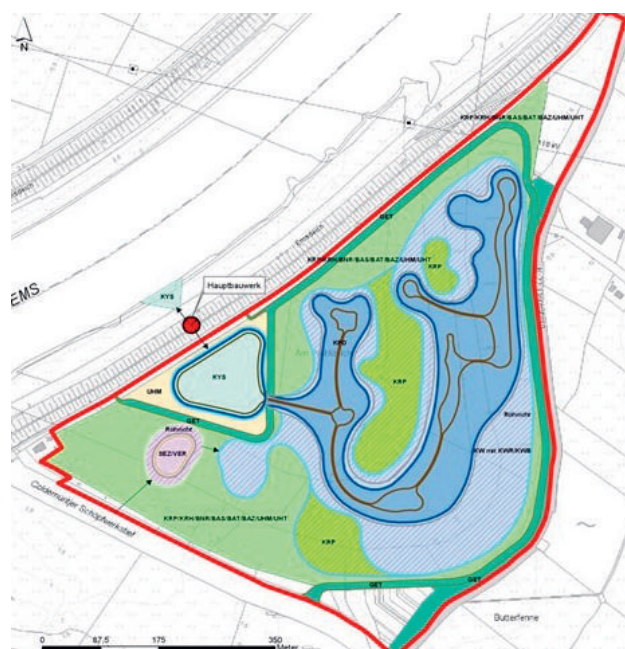
Abbildung 8: Auszug aus der Machbarkeitsstudie zum Tidedepolder Coldemüntje (Schaffung ästuariner Lebensraumtypen); mittels eines Einlassbauwerks im Deich wird die ehemalige Flusschleife wieder der Tide-Dynamik unterworfen; blau: Flächen mit regelmäßigem Tideeinfluss (Sub- und Eulitoral), grün: höher liegende Bereiche und neue Verwaltung.
