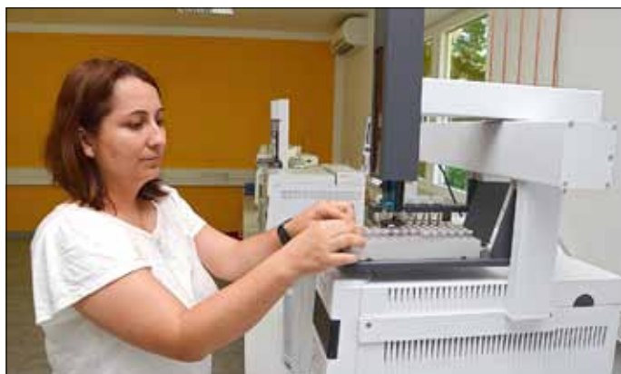
Analytik auf höchstem Stand: LWU-Mitarbeiterin Maria-Fernanda Troja-Pauker bestückt den Auto-Sampler eines Massespektrometers.
