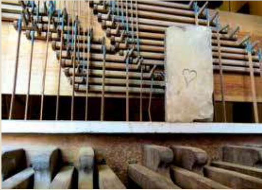
Bärbel Wunsch: Ziegelstein mit Herz zur Beschwerung des Blasebalgs in der Dorfkirche Jühnsdorf (Teltow-Fläming)
