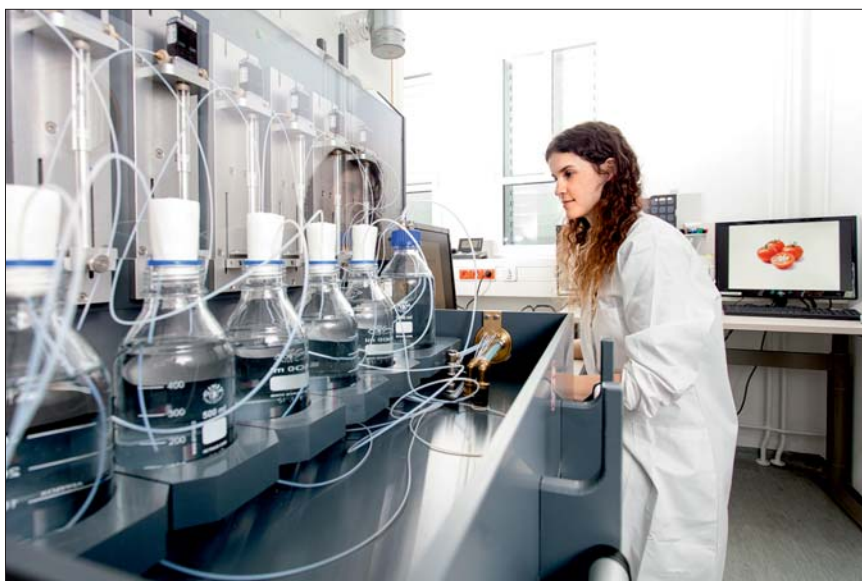
3 Im Labor der Nachwuchsgruppe Psychophysiologie der Nahrungswahrnehmung wird mittels eines computer-gesteuerten Gustometers die Geschmackswahrnehmung der Probanden untersucht. Das Gerät erlaubt es, verschiedene Geschmackslösungen automatisiert mit höchster Präzision bezüglich der Menge, Dauer und Temperatur zu verabreichen.
