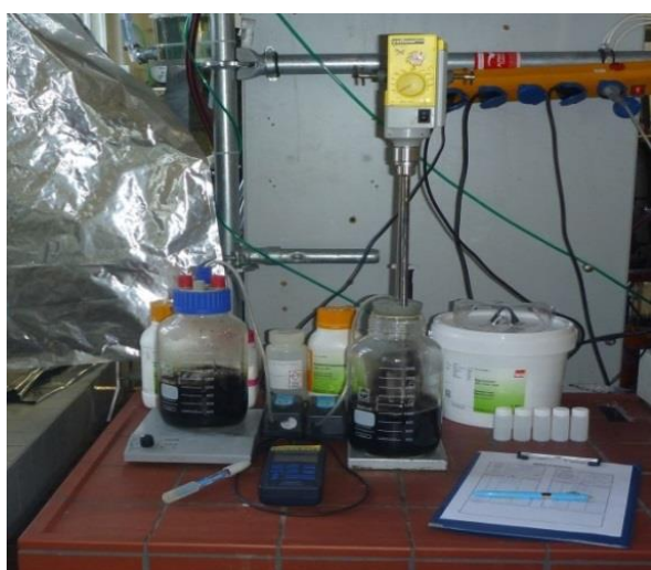
Abb. II.1.6-1: Versuchsanordnung zu vom Hauptprozess entkoppelten Vorversuchen zur MAP-Fällung.
