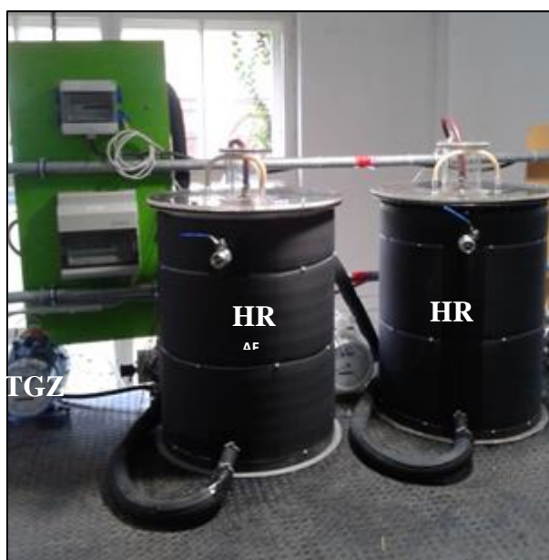
Abb. II.1.1.1-2: Bild des satzweisen (hyper)thermophil betriebenen Leachbedfermentationssystem. Links: auf einem Tragegerüst stehende Hydrolysereaktoren daneben ein Trommelgaszähler (TGZ) zur quantitativen Erfassung des produzierten Biogases Rechts: Anaerobfilter (AF), Perkolatspeicher (PS), Messbox (MB), Sandfilter (SF)
