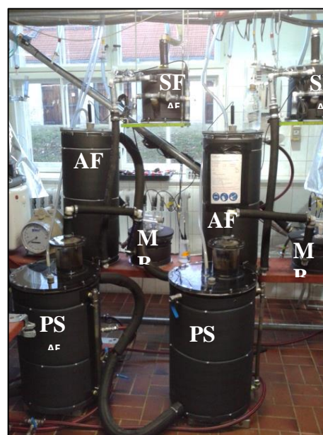
Abb. II.1.1.1-2: Bild des satzweisen (hyper)thermophil betriebenen Leachbedfermentationssystem. Links: auf einem Tragegerüst stehende Hydrolysereaktoren daneben ein Trommelgaszähler (TGZ) zur quantitativen Erfassung des produzierten Biogases Rechts: Anaerobfilter (AF), Perkolatspeicher (PS), Messbox (MB), Sandfilter (SF)
