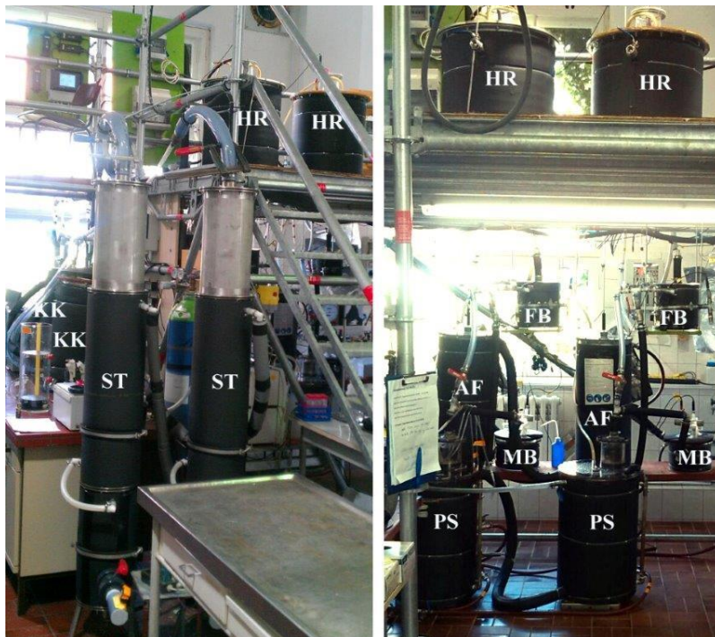
Abb. II.1.1.1-10: Bild des satzweisen (hyper)thermophil betriebenen Leachbedfermentationssystem und dem entwickelten System zur Luftstrippung. Das Leachbedsystem setzt sich aus 2 Triplets zusammen, die aus Hydrolysereaktor (HR), Anaerobfilter (AF) und Perkolatspeicher (PS) bestehen. Filterbox (FB), Messbox (MB), Strippkolonne (SK), Kühlkolonne (KK)
