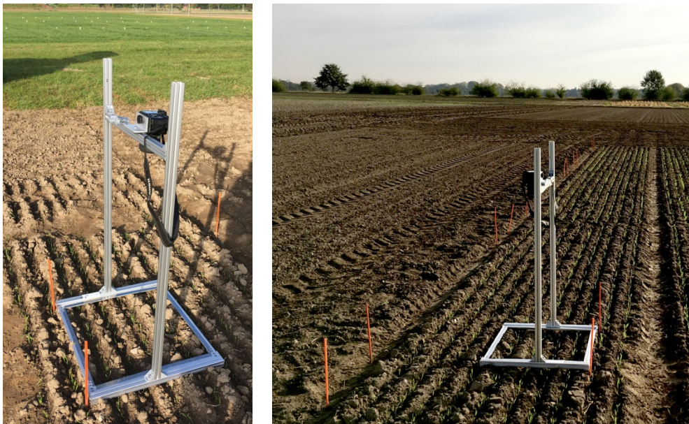
Abbildung 1: Kamerahalterung und 50 x 50 cm Rahmen für die Feldbonitierung
