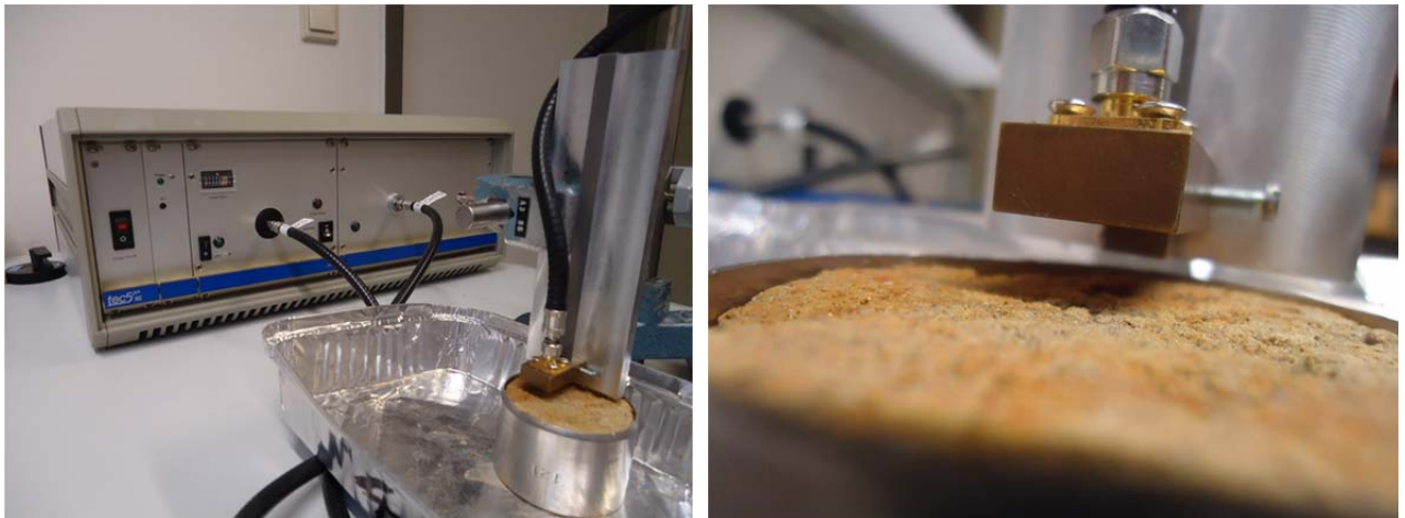
Abbildung 2: Messaufbau im Labor, die ungestörte Bodenprobe im Stechzylinder wurde unterhalb des optischen Fensters platziert, die rechte Abbildung zeigt im Detail den Abstand zwischen optischem Fenster und der Bodenprobeoberfläche
