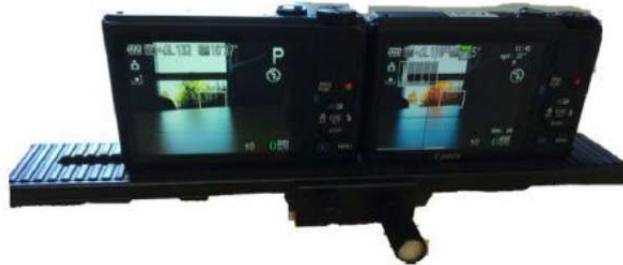
Abbildung 2: Verwendetes Kamerasystem aus einer Canon Powershot S100 (links) und einer modifizierten Canon Powershot S110 (rechts), beide befestigt auf einer Aluminium-Gleitschiene
