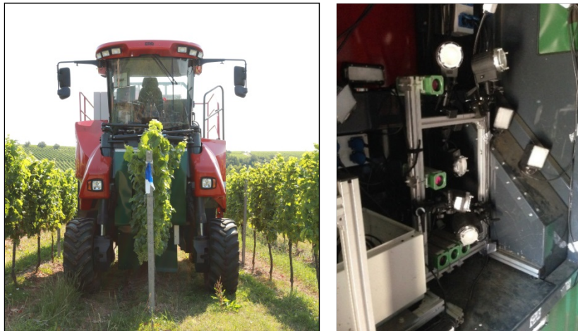
Abbildung 1: Phenotyping Plattform Phenoliner (KICHERER, 2017). Links: Einsatz des Systems bei einer Reihe von Weinstöcken. Rechts: Kamerasystem mit über- und nebeneinander angeordneten Kameras
