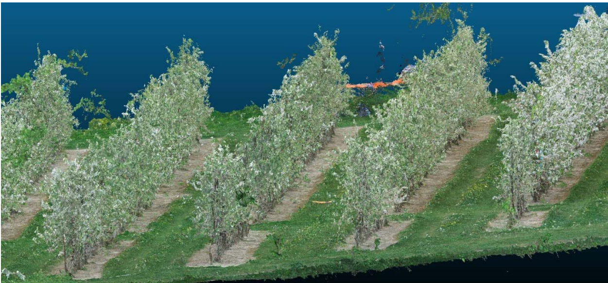
Abbildung 2: Punktwolke dreier Reihen des Quartiers 15.1+2 des KOB nach photogrammetrischem Ansatz
