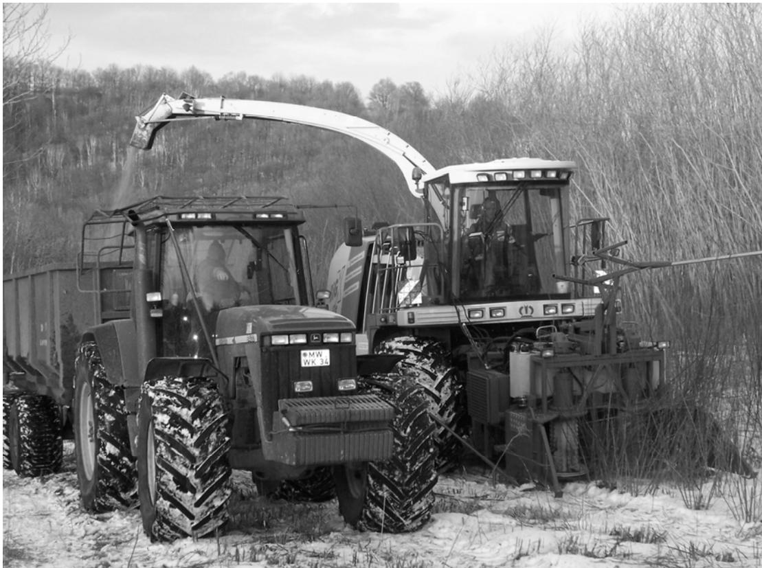
Abb. 3 : Feldhäcksler mit Spezial-Schneidwerk bei der Weidenernte
