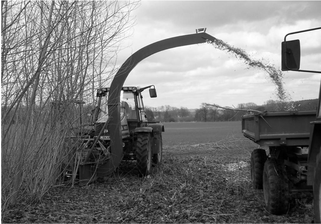
Abb. 4: Erprobung des einreihigen Anbau-Mähhackers in einem Pappelbestand
