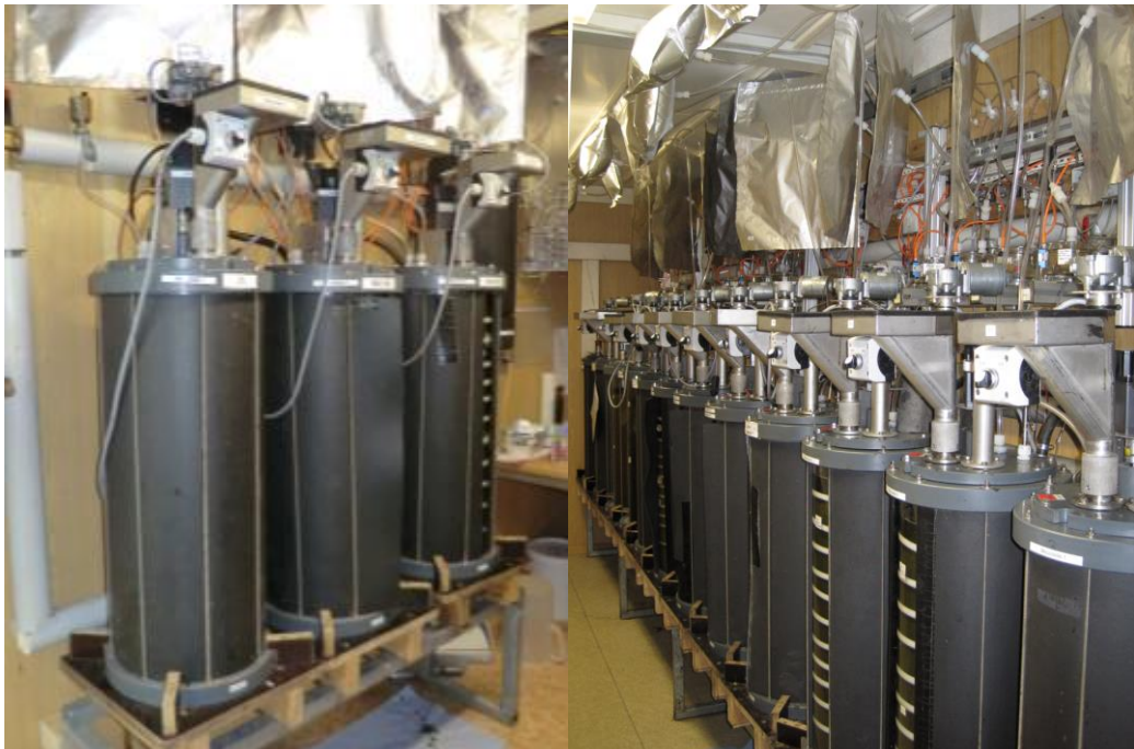
Abbildung 2: 32 L Durchflussfermenter des Instituts für Landtechnik und Tierhaltung
