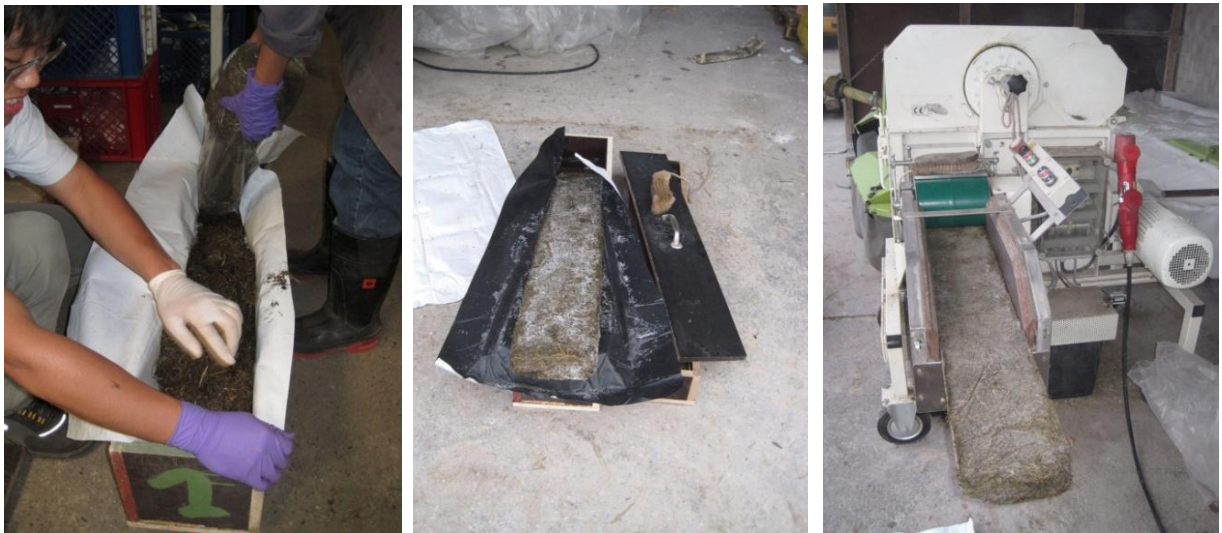
Abbildung 3: Herstellung von gefrorenen „Substratbalken“ für die Nachzerkleinerung mit einem Laborhäcksler
