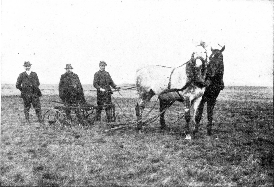
Abbildung 1. Federzahnkultivator mit Wiesenriher zur Bearbeitung stark vermooster Wiesen und zum Verwunden der Narbe.
