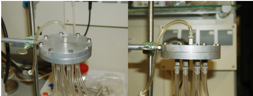
Abbildung 14: Weiterentwicklung des Gas-Verteilers mit druckgesicherter Technik zur gleichzeitigen Anaerobisierung von 12 Kulturröhrchen durch Evakuierung mit Hilfe einer Vakuumpumpe und Begasung mit reinem Stickstoff.
