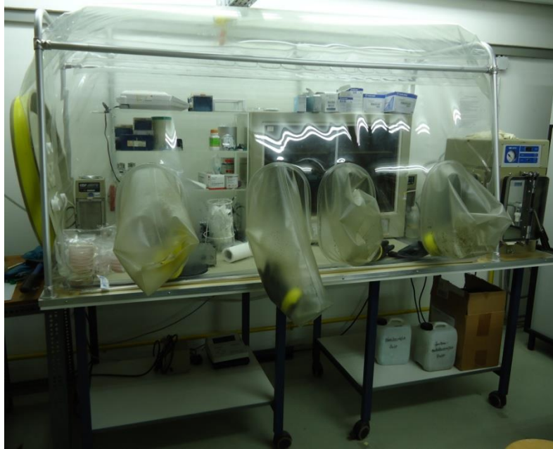
Abbildung 3: Anaerobenzelt. Die anaeroben Arbeiten wurden in einem Anaerobenzelt (Firma Coy Laboratory Products, Michigan, USA) mit Formiergasatmosphäre ( N_2/H_2 95/5) durchgeführt.
