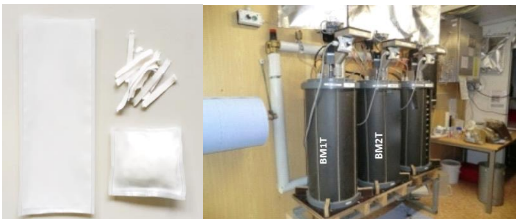
Abbildung 15: Nylonsäckchen für die „ in sacco “ Versuche; Laborfermenter BM1T, BM2T für die „ in vivo “ Anreicherung
