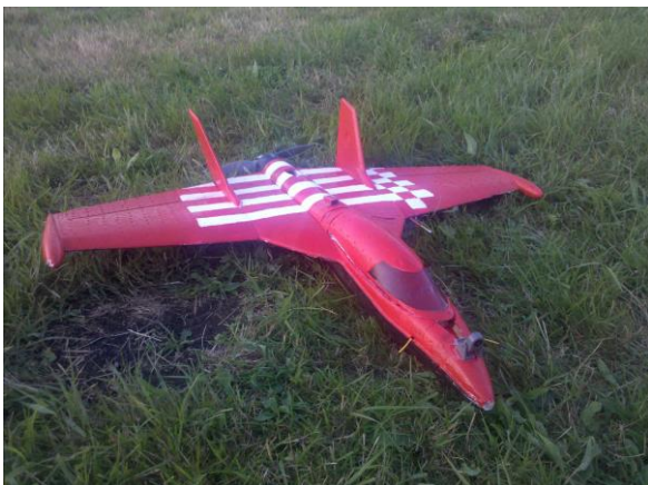
Abbildung 3: Funjet zur Messung von Luftdruck, Temperatur und Luftfeuchte 900 g, 80 cm Spannweite, Flugzeit 45 Minuten, der Funjet wurde durch (REUDER et al. 2008) als SUMO eingeführt.
