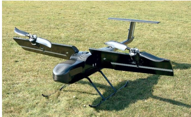
Abbildung 3: Kippflügel-RPA im Transitionsflugmodus
