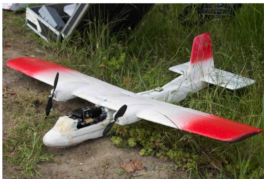
Abbildung 5: Umgerüstetes Fluggerät mit inertialer Lagemessung, verbessertem Antrieb und montierter Fotokamera, Startmasse 2080 g, Flugzeit 30 Minuten
