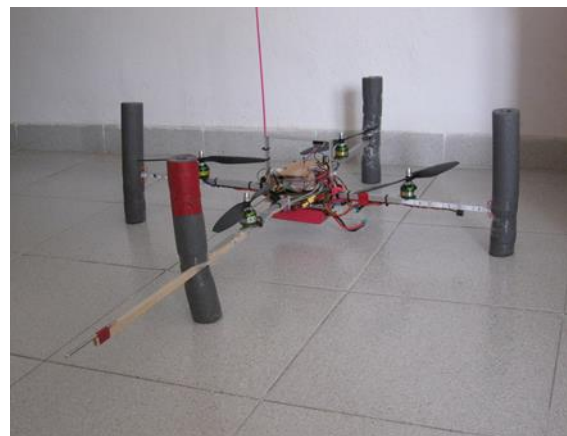
Abbildung 4: HB-Kopter zur Messung der Windgeschwindigkeit, des Luftdrucks und der Temperatur, 1200 g, 13 Minuten Flugzeit HBMINI Autopilot
