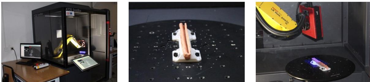
Abbildung 6: (von links beginnend) Photographie der verwendeten ATOS Scan-Box 4105 mit dazugehörigem Messplatz für die Programmierung und Einstellung des Roboterarms. Als nächstes ist die montierte Probenhalterung der Schneidenabdrücke auf dem Drehtisch abgebildet.
