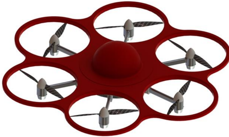
Abbildung 2: Konstruktion Hexacopter mit seitlichem Propellerschutz. Konstruktionsmaterial GFK.
