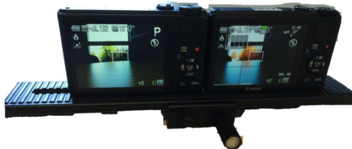
Abbildung 4: Befestigungsweise der beiden Digitalkameras auf der Aluminium-Gleitschiene
