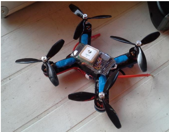
Abbildung 1: MAV Wanze, 206 g, 100 mm HBMIN Autopilot von 2013
