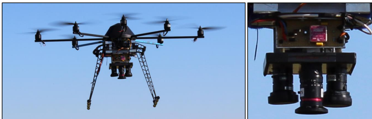
Abbildung 2: ThünoCopter mit Multi-Sensor-Kamera von VRmagic und Objektiven von Kowa zur Befliegung von landwirtschaftlichen Versuchsflächen und Erfassung der spektralen Reflexion im RGB- und NIR-Bereich.
