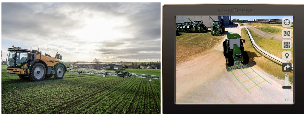
Abbildung 1: Beispiele für den Kameraeinsatz in der Landwirtschaft: Teilbreitensteuerung auf Grundlage einer Bildanalyse (links, Quelle: AgriCon GmbH); „Birdview“ mit erweiterter Realität auf Grundlage mehrerer Kamerasysteme zur Fahrerassistenz (rechts, Quelle: John Deere).
