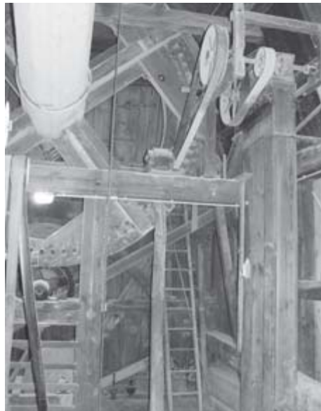
Hier ist das Herz der Mühle. Wenn ein riesiger Balken gehoben wird, ist das Windrad freigegeben. Steht es richtig im Wind, kann der Müller Getreide mahlen. Es sieht gewaltig aus, was man schon vor 150 Jahren gebaut hat.
