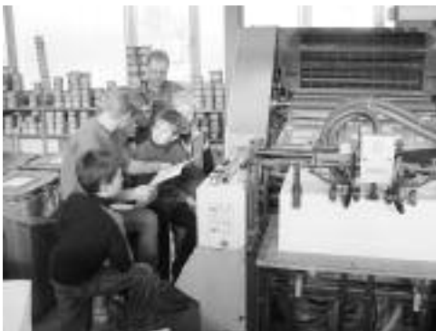
5. Extra für uns wurde der Plattenbelichter aufgeschraubt um zu zeigen, wo die kunststoffbeschichtete, lichtempfindliche Druckplatte sich bei der Laserbelichtung entlang schlängeln muss.
