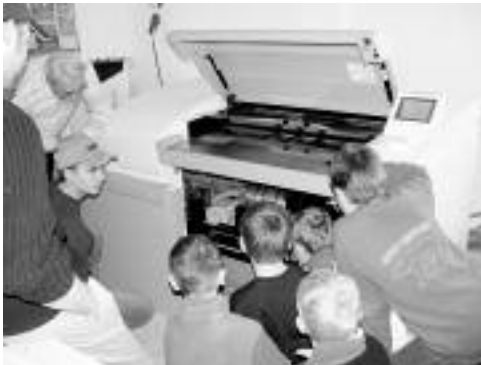
5. Extra für uns wurde der Plattenbelichter aufgeschraubt um zu zeigen, wo die kunststoffbeschichtete, lichtempfindliche Druckplatte sich bei der Laserbelichtung entlang schlängeln muss.
