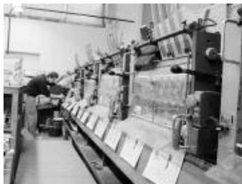
8. Diese Falzmaschine zieht die A2-Blätter vom rechten Stapel ein, zieht sie hoch und zack - wird der erste Falz gelegt. Im 90-Grad-Winkel "fliegen" die Blätter weiter, werden wieder hochgezogen - zack, ist der zweite Falz da.
