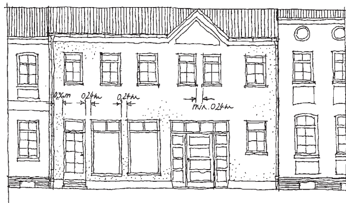
Fenster und Schaufenster, Formate, Anordnung, Pfeilerbreiten, § 4 Abs. (5)
