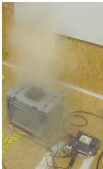
Abbildung 23 Vorrichtung geregelter Feuchteemission, Bildmitte: Behälter (steht auf einer Waage), aus dem Nebel austritt; links unten: Messung, Regelung, Ansteuerung und Stromversorgung
