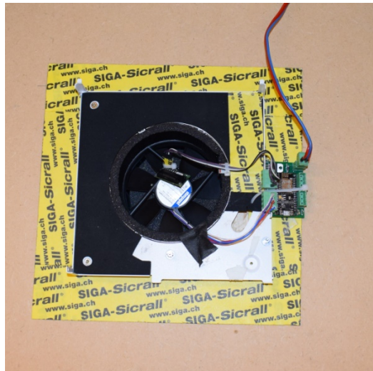
Abbildung 22: Aktiver Überströmer mit Ansteuerung und CO 2 -Sensor
