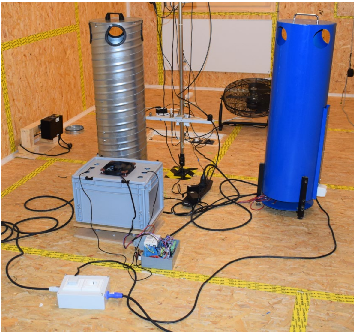
Abbildung 24 Zwei thermische Dummies mit Steuerungselektronik, im Vordergrund Vorrichtung zur Feuchteemission
