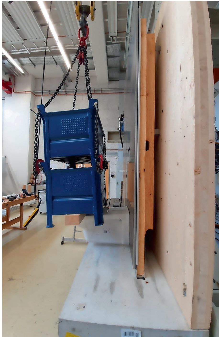
Abb. 3: Konsollastprüfung in Anlehnung an DIN EN 997: 2015-09 sowie VDI 6000 zur Beurteilung des Bruch- und Verformungsverhaltens der Gesamtkonstruktion. Bild: TH Rosenheim
