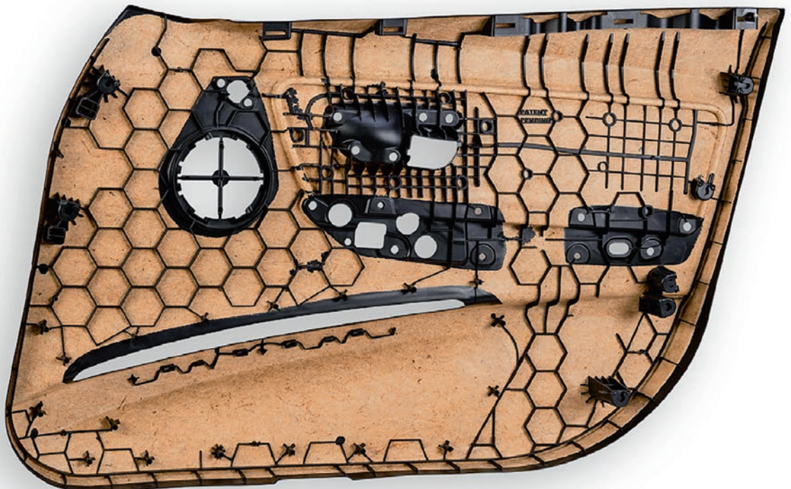
Abb. 1: Türverkleidung im Automobilinterieur (Hybridverbund aus Naturfasern und Kunststoff) [1]
