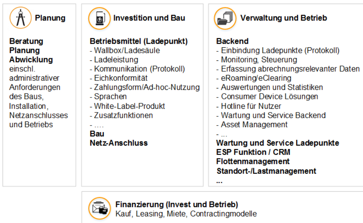
Abb. 21: Mögliche Leistungsumfänge von Ladeinfrastrukturnetzen (Lastenheft)
