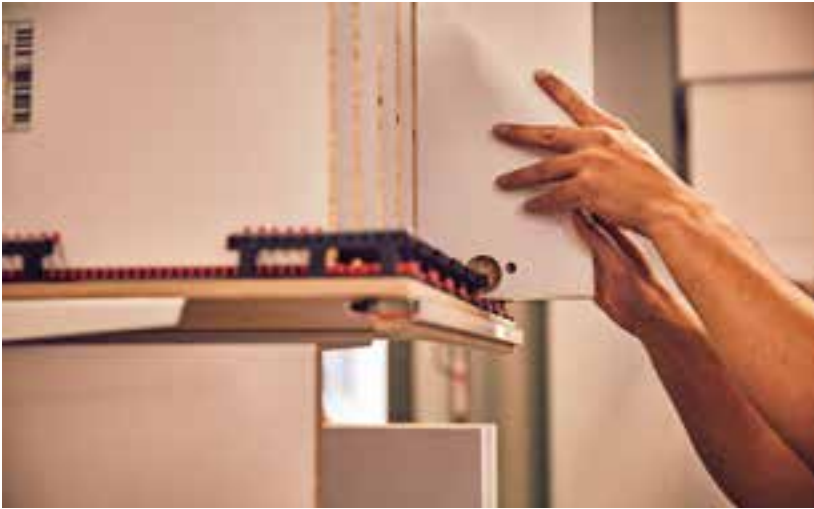
Abb. 4: Der Mensch wird in den Prozess integriert: Über das Pick-by-Light kann der Mitarbeiter manuell Teile in den intelligenten Auftragscontainer sortieren.
