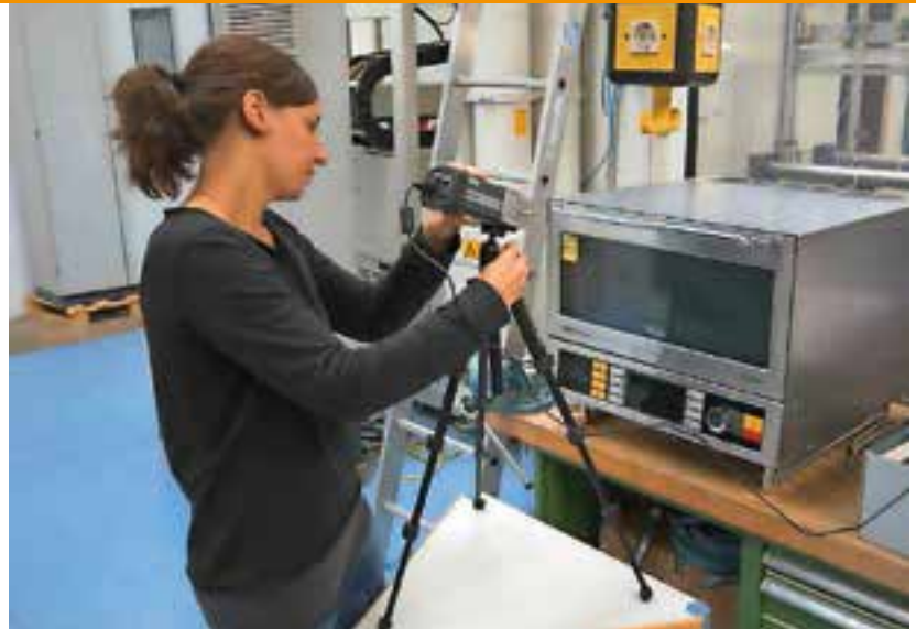
Abb. 3: Versuchsaufbau zur Messung der Temperaturen der Demonstratorformteile im Mikrowellenofen
