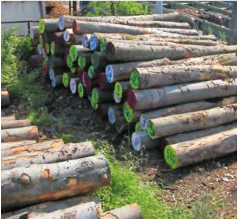
Abb. 2: Der Gesamtprobenumfang betrug 72 Buchenstämmen, die schließlich zu Lamellen verarbeitet wurden.
