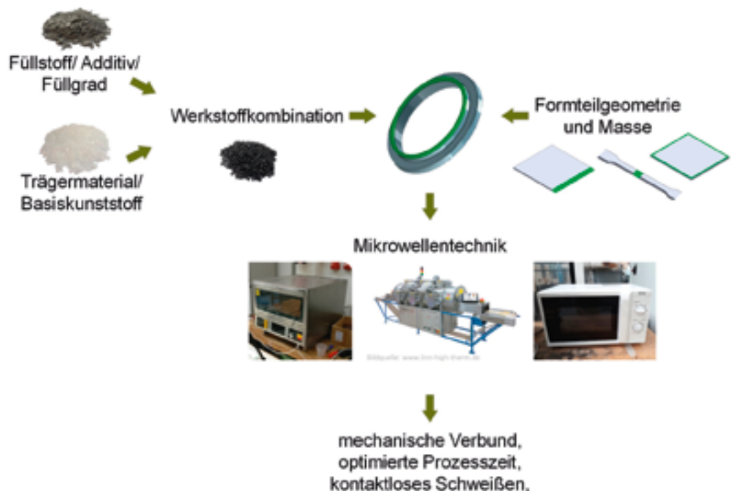
Abb. 1: Einflussfaktoren für das Verschweißen von Kunststoffen mittels Mikrowellenstrahlen.
