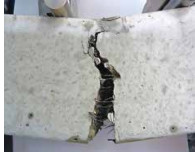
Abb. 2: Untersuchungen zur Anbindung und Festigkeit der Faser sind zentrale Aufgabe des Projekts. Hier zu sehen ist der Bruch eines Betonträgers während eines Biegeversuchs. In der Bruchfläche sind die eingearbeiteten Fasern klar erkennbar.
