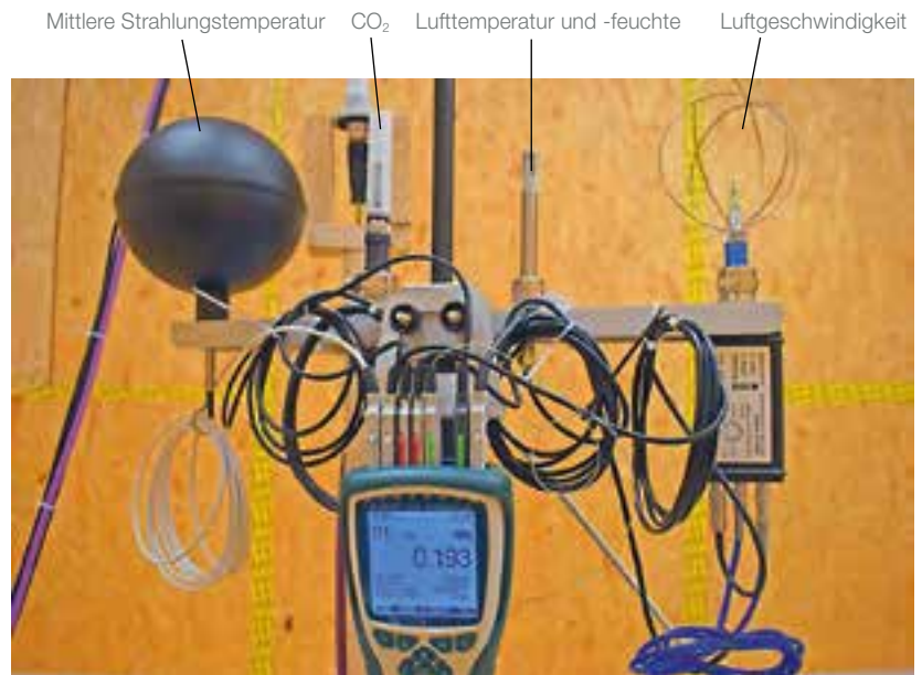
Abb. 3: Behaglichkeits-Messbaum zur Messung der thermischen Behaglichkeit.
