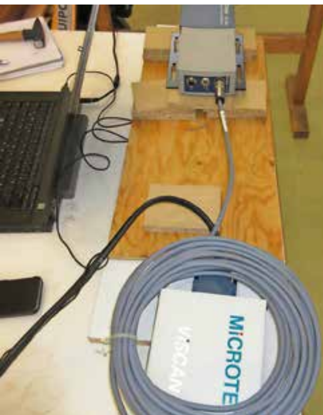
Abb. 3: Dynamische E-Modul Ermittlung mit portablen Viscan. Bild: Fa. Microtec
